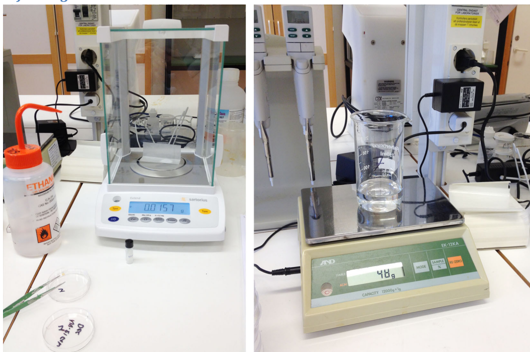
Figur 8 Vägning av vatten samt det utfällda bariumsulfatet
