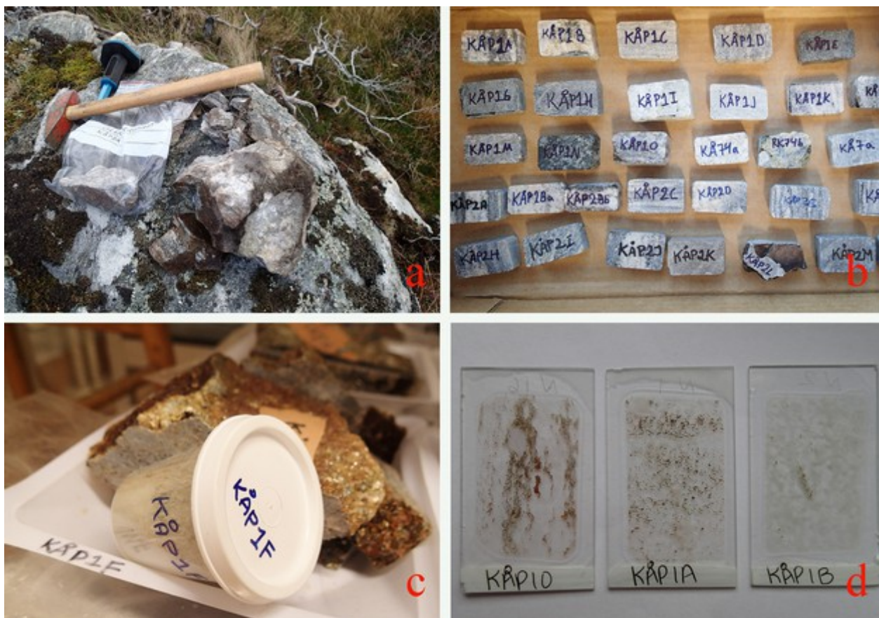
Illustration 3: Foto a visar lokal 1a i fält (den geologiska hammaren är cirka 50 centimeter), b visar knappt hälften av de klossar som sågats ut för tunnslipsframställning, c visar burk med stenpulver för mätning med hjälp av XRF. Med på samma bild syns också delar som blev över av stenprover och som har bevarats tills vidare. Bild d visar tre av de färdiga tunnslipen.
